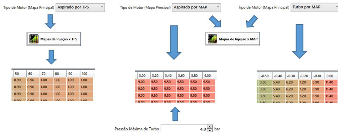
Figura 16-Interação entre o Tipo de Motor, Pressão Máxima de Turbo e as Colunas dos mapas.
